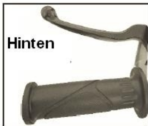
Bremshebel Hinterradbremse, gleichmäßig ziehen
