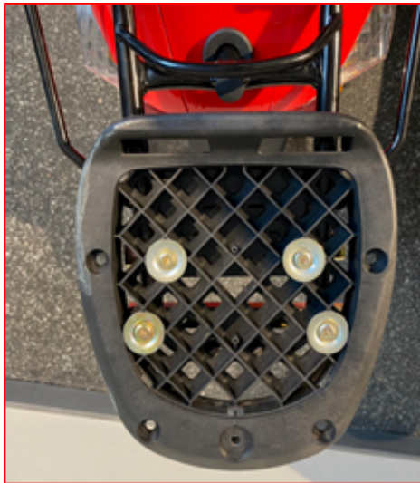
Bild 2 - fixierte Bodenplatte (oben)
