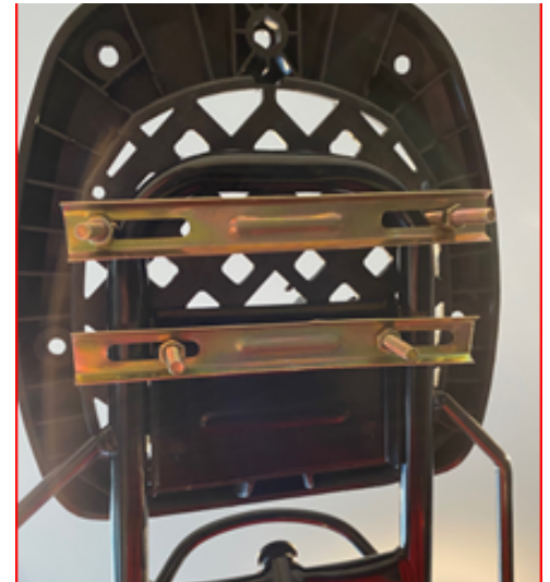
Bild 3 - fixierte Bodenplatte (unten)
