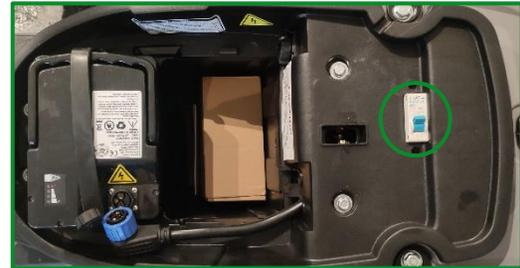
Anschließend schließen Sie den Konnektor an den Akku an.
