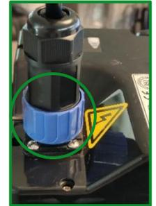
An der Seite des Ladegerätes finden Sie eine Sicherung mit der Beschriftung „FUSE“. Sollte Ihr Ladegerät nicht funktionieren, überprüfen Sie bitte als erstes diese Sicherung. Sollte diese beschädigt sein (z.B. durchgebrannt oder schwarz verfärbt), haben Sie in dem Karton des Ladegerätes zwei Ersatzsicherungen, um die beschädigte zu ersetzen.
